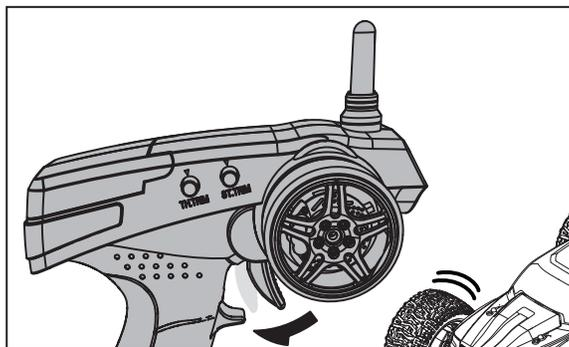
4. Fahren Sie langsam los. Sollte das Fahrzeug nicht geradeaus fahren justieren Sie den Geradeauslauf mit der Lenkungstrimmung.
