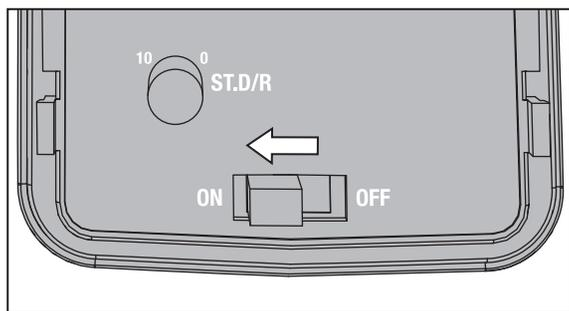
2. Verbinden Sie den Fahrakku mit dem Regler und schalten den Regler ein.
