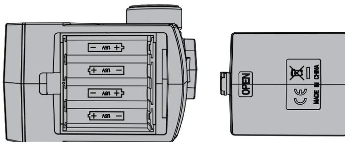
1. Öffnen Sie den Batteriefachdeckel an der Unterseite des Senders.
