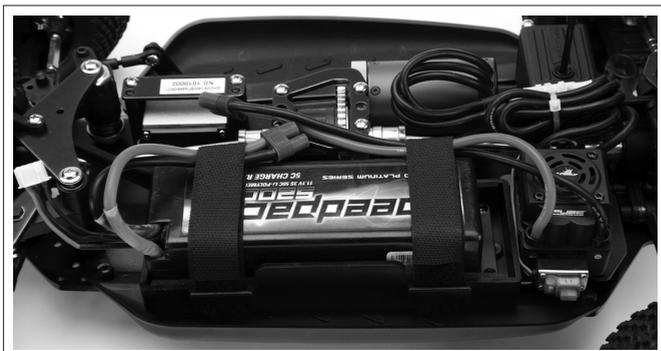
1. Lösen Sie die Rändelschraube um den Akkuhalter zu entfernen.
