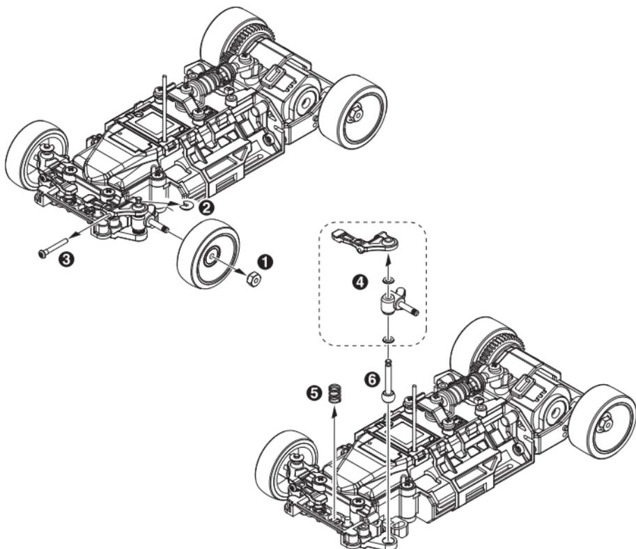
► How to remove the C-Ring. / So entfernen Sie den C-Ring!
