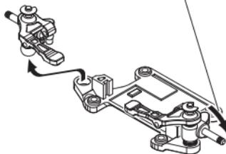
**Installing the narrow front suspension / Einbau der schmalen Spur an der Vorderachse**
