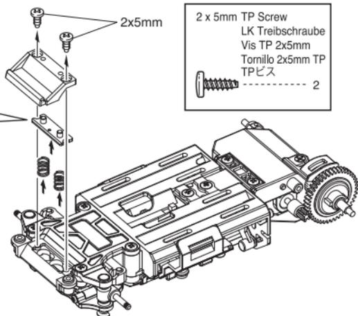
**How to remove Rear Spring. / So tauschen Sie die hinteren Federn aus!**
