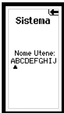
Per il nome dell'utente si possono impostare fino a 10 caratteri. Questo nome viene visualizzato nella schermata principale (Main Screen). Nella schermata Sistema (System) basta evidenziare il nome utente e premere il Roller per entrare in questa funzione. Scegliere la posizione con il Roller, poi premerlo per accedere al carattere. Il nome utente vale per tutti i modelli.
