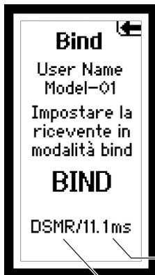
Il processo di collegamento (bind) serve a far apprendere alla ricevente il codice specifico della trasmittente chiamato GUID (Globally Unique Identifier) e per memorizzare i valori di Failsafe. Quando una ricevente è collegata ad una memoria di modello o a una trasmittente, la ricevente risponderà soltanto a quella specifica memoria di modello o trasmittente (per maggiori informazioni vedi Model-match).
