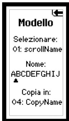
Usare il menu "Modello Selezionare" per cambiare il modello memorizzato, per assegnare il nome a un modello o copiare un modello. Il trasmettitore DX4R PRO dispone di 50 memorie.
