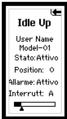
Idle Up (chiamato anche high idle) è usata per avanzare la posizione del throttle nelle auto a benzina durante l'avvio per evitare che il motore si spenga perché è ancora freddo.
