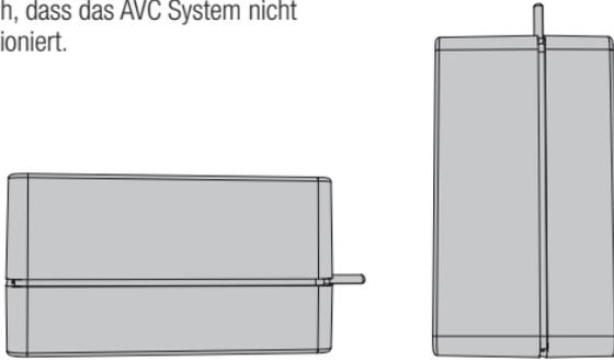
Montieren Sie den Empfänger in ihrem Fahrzeug mit dem doppelseitigem Klebeband. Das Schaumtape hält den Empfänger in Position und sichert ihn vor Vibrationen.
