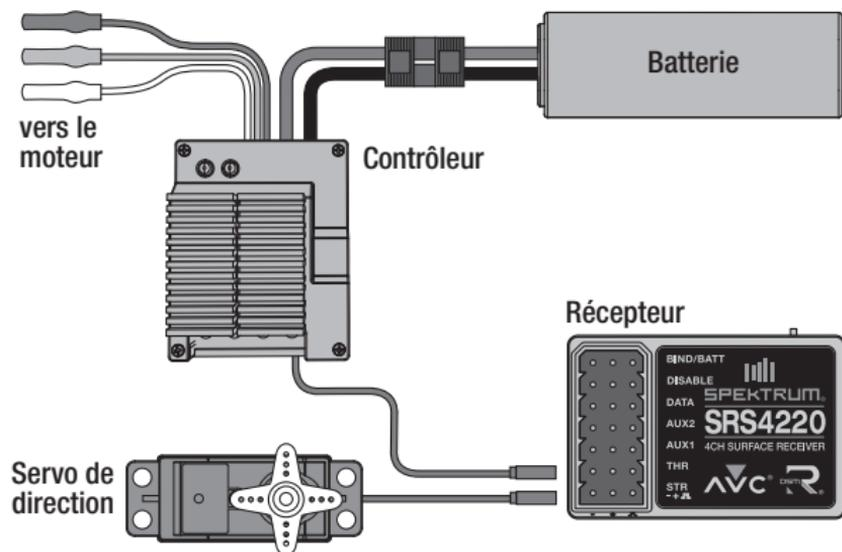
**IMPORTANT:** Si vous agissez sur le trim des gaz ou de la direction à l'émetteur, le récepteur devra être mis hors tension puis réactivé pour enregistrer les nouvelles position des trims. Autrement l'AVC ne fonctionnera pas correctement.
