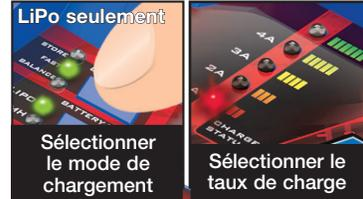
Appuyer et maintenir pour 2 secondes sur le bouton de démarrage. Appuyer une fois pour arrêter.
