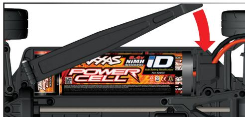
**Nota:** Después de instalar la batería y volver a instalar la carrocería en el chasis, asegure la carrocería con los ganchos de carrocería incluidos. Coloque los ganchos de carrocería delanteros como se muestra para que entren en el compartimento adecuado.
