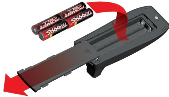
Su transmisor TQi utiliza 4 baterías AA. El compartimento para baterías está ubicado en la base del transmisor.
