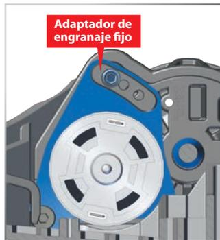
Si elige hacerlo, también puede configurar la malla del engranaje manualmente sin usar el adaptador de engranaje fijo. Con el adaptador removido, Afloje el tornillo del motor. Corte una tira delgada de papel de cuaderno y colóquela en la malla del engranaje del motor. Deslice el motor y el piñón del engranaje cilíndrico. Vuelva a ajustar el tornillo del motor y luego retire la tira de papel. Usted podrá colocar una nueva tira de papel entre los engranajes sin causar agarrotamiento.
