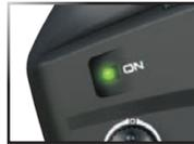
Si el led de estado parpadea en rojo, las baterías del transmisor pueden estar con poca carga, sin carga o quizá mal instaladas. Reemplace con baterías nuevas o recién cargadas. La luz indicadora de energía no indica el nivel de carga del paquete de baterías instalado en el modelo. Consulte la sección de resolución de problemas de la página 17 para obtener más información sobre los códigos del led de estado del transmisor.
