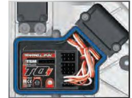
**Nota:** Para obtener un mejor rendimiento, se recomienda que se instale este receptor en la orientación original como se muestra.
