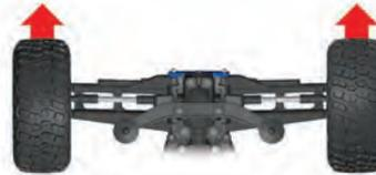
7. Maneje con suavidad el gatillo de velocidad para asegurarse de tener marcha adelante y marcha atrás y de que el motor se detiene cuando el gatillo de velocidad está en posición neutral.
