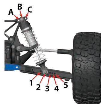
La suspensión de su modelo se ha configurado para un rendimiento todoterreno (posición 2 en los brazos de suspensión delanteros y posición 3 en los brazos de suspensión traseros). Si tiene planeado conducir en superficies duras, deberá realizar los siguientes cambios:
