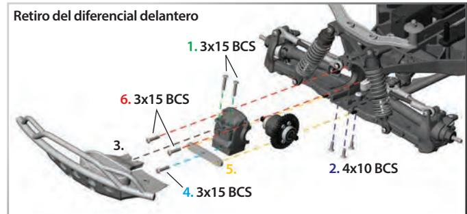
4. Retire el tornillo de cabeza semiesférica del 3x15 mm de la barra de acoplamiento del diferencial.
