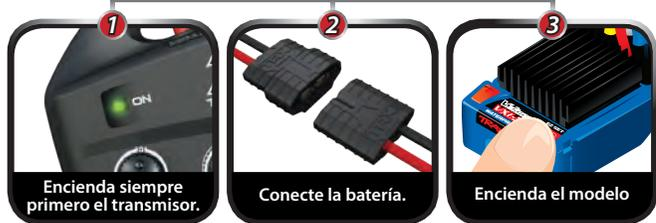
• Para que el transmisor y el receptor se conecten entre sí, el receptor en el modelo debe encenderse dentro de los 20 segundos posteriores a encender el transmisor. La luz de led del transmisor parpadeará rápido en rojo, lo que indica una falla en la conexión. Si perdió la conexión, simplemente apague el transmisor y comience de nuevo.
