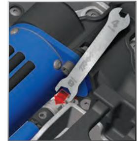
Coloque el modelo en una superficie de alta tracción, como una alfombra. Regule el embrague antirrebote de forma tal que pueda oírlo deslizarse por aproximadamente dos pies desde la posición de detenido a toda aceleración. (Conozca más acerca del ajuste del embrague antirrebote en la columna lateral).
