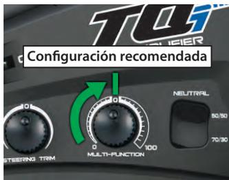
Gire la perilla hacia la derecha para aumentar la asistencia; gire la perilla hacia la izquierda para disminuir la asistencia. Al girar la perilla hacia la izquierda hasta el tope se apaga completamente la TSM.
