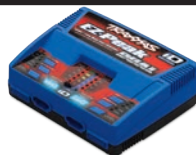
Cargador equilibrado de polímero de litio (LiPo) EZ-Peak Dual recomendado (pieza n.º 2972)
